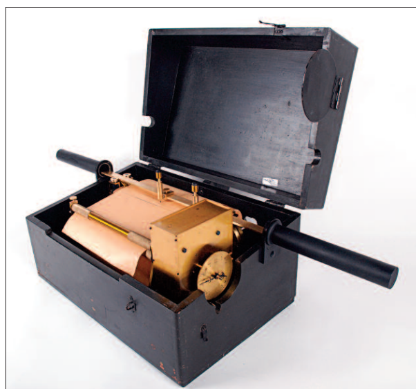
Fig. 1. Le limnigraphe enregistreur de Sarasin. Collection du Musée d'histoire des sciences, Genève, © MHS.
